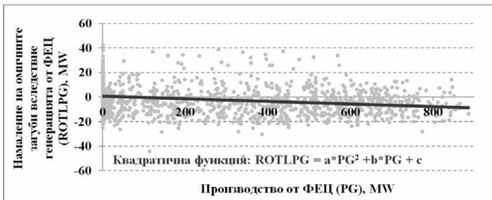
Фигура 3. Намаление на омични загуби в зависимост от производството на ФЕЦ
