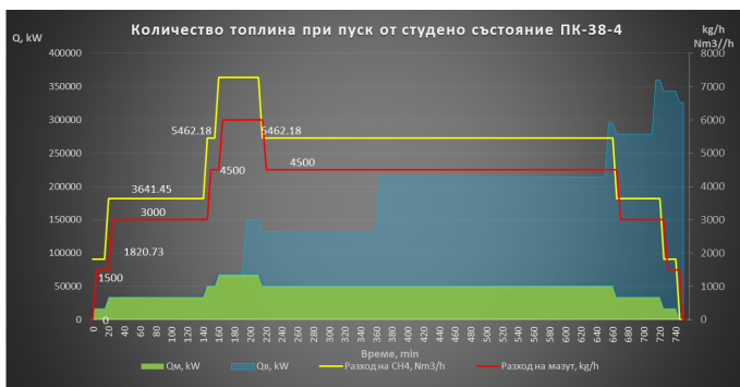
Фигура 2. Количество топлина при пуск на блок 177 MW от студено състояние
