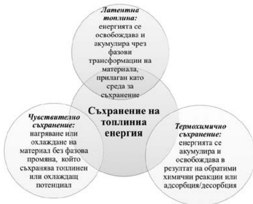
Фиг. 1. Механизми на съхранение на топлинна енергия.
