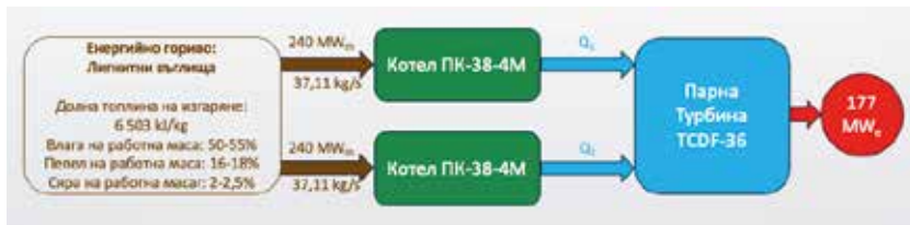
Фиг. 1. Принципна схема на блок 177 MW
