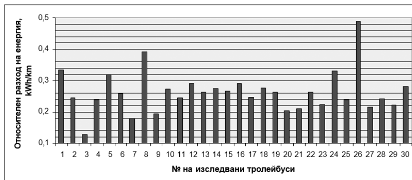
Фиг. 3. Относителен разход за отопление на изследваните тролейбуси
